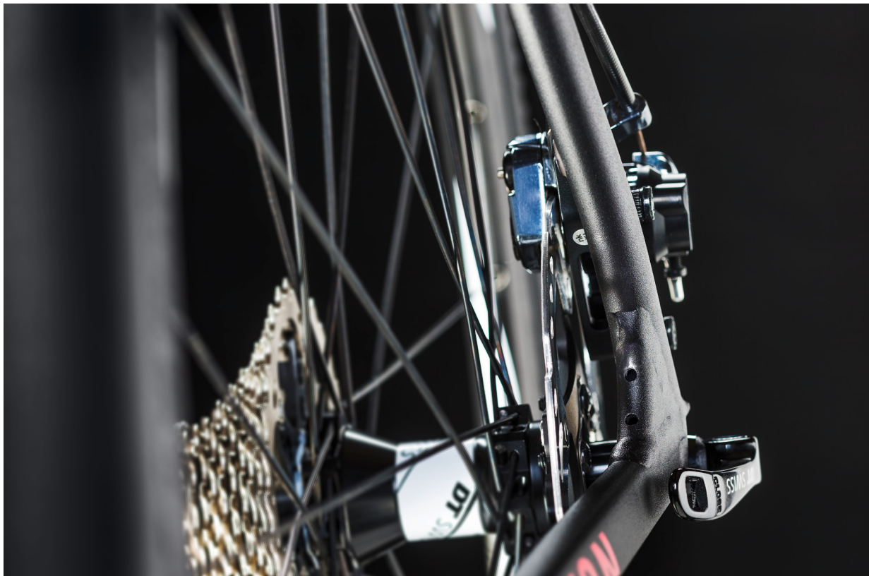
Abbildung 5: Assymetrischer unterer Teil der linken Kettenstrebe mit Gusset
