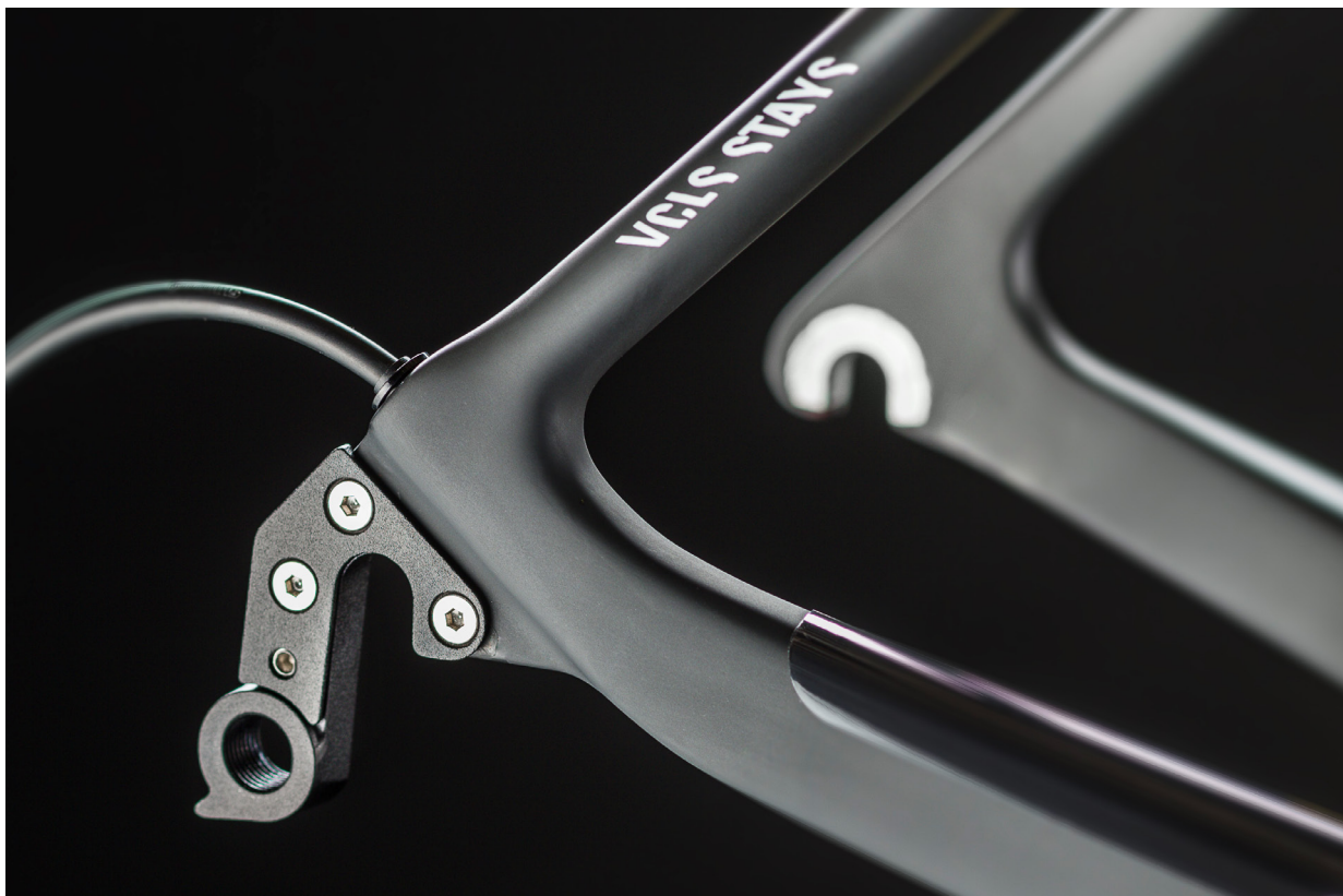
Abbildung 6: 3-fach verschraubtes Schaltauge
