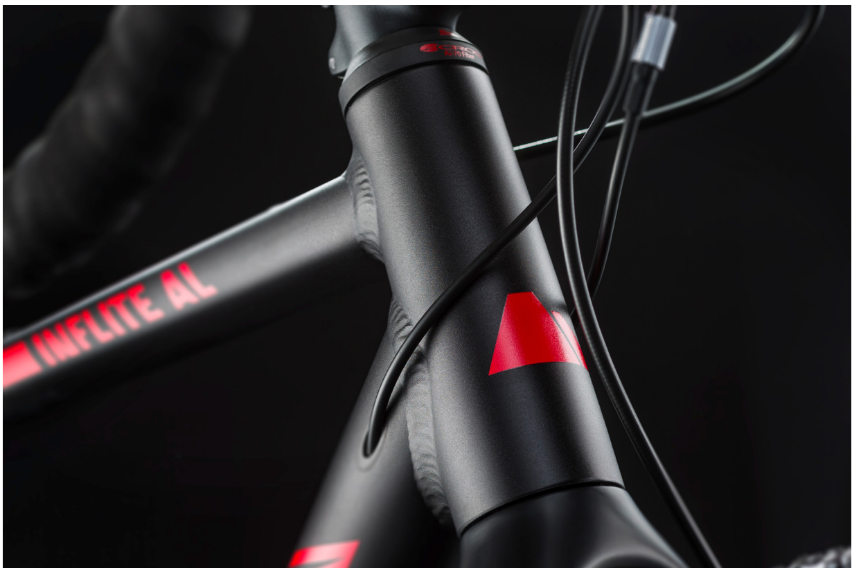
Abbildung 2: Zugverlegung im Steuerrohrbereich
