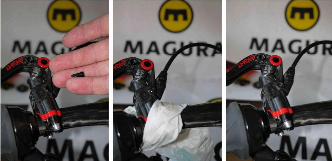
Achten Sie darauf daß das Öl am EBT bis oben ansteht und verschließen die Bremse nun mit der EBT Schraube. Drehen Sie die EBT Schraube ein bis diese **BÜNDIG** mit dem Gehäuse ist.
