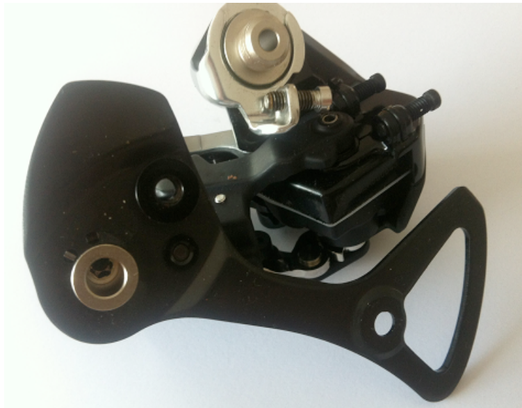
Schaltwerk ohne Schaltungsrädchen
