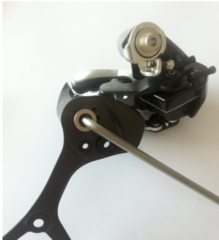
Nach Entfernen des Anschlagbolzen und Aufhebung der Federspannung Demontage des Schaltwerkbolzen
