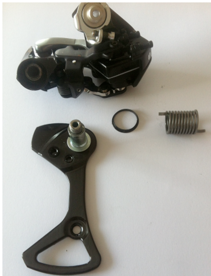
Nach Entfernen des Anschlagbolzen und Aufhebung der Federspannung Demontage des Schaltwerkbolzen
