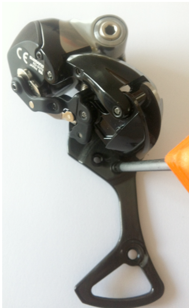
Entfernen des Anschlagbolzen am Original-Schaltwerkkäfig, dadurch Aufhebung der Federspannung
