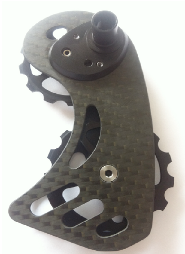
Vorbereiten des BERNER-Schaltwerkkäfig zur Montage
